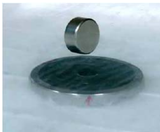
図1 銅酸化物超伝導体が液体窒素で冷却され、超伝導状態となって、ピン止め効果で磁石を浮上させている（磁気浮上）。
