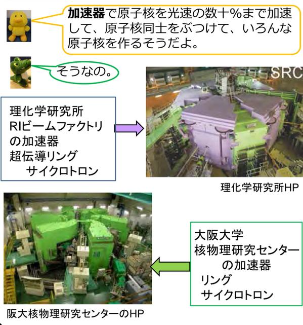
加速器で原子核を光速の数%まで加速して、原子核同士をぶつけて、いろんな原子核を作るそうだよ。
