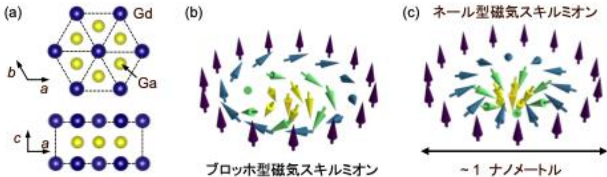
図 1. (a) 研究対象物質 \text{GdGa}_2 の結晶構造。(b) 先行研究で発見されたブロッチ型磁気スキルミオン。(c) 本研究で提案したナノメートルサイズのネール型磁気スキルミオン。
