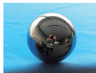
キログラムの新しい定義を実現するために用いられる直径約94 mmの単結晶シリコン球体。
