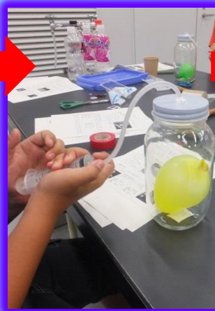
完成した真空ポンプのビンに少し膨らませた風船を入れ、ビンの中の空気を抜くと・・・
