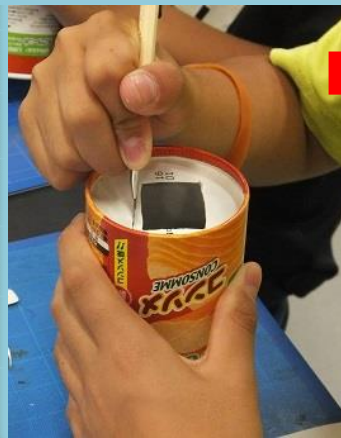
簡易分光器を手作りました。使用した材料や道具は、円筒形のお菓子の箱、回折格子、カッター、カッターマット、はさみなど。
